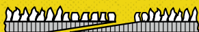
Forma 2 Šikmý řez, slepeno s přesahem, hroty zrn obroušeny pro dosažení klidného chodu pásu.
