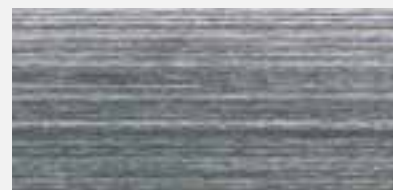
Brusný lamelový kotouč se zrnem 40 Dlouhé průběžné čáry, Minimální prohloubení, Hladký koncový brus
