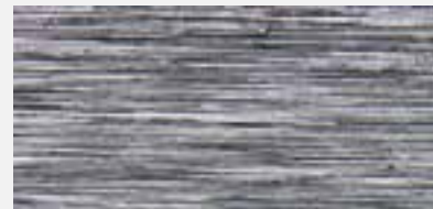
Brusný pás se zrnem 40 Krátká výrazná struktura čar, Drsný povrch, Kontrastní koncový brus
